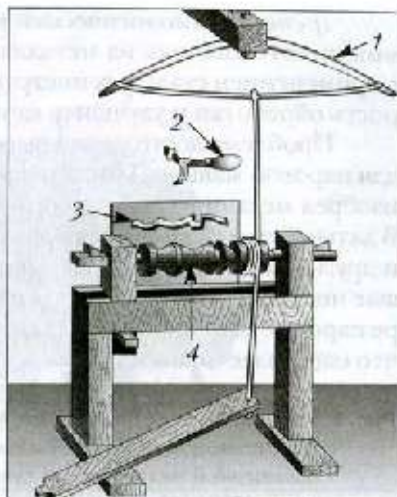
Рис. 3. Станок с лучковым приводом: 1 — упругое звено (лучковый привод); 2 — инструмент, с помощью которого отслеживали форму шаблона и обрабатывали заготовку; 3 — шаблон (прорезь в стенке станины); 4 — заготовка
