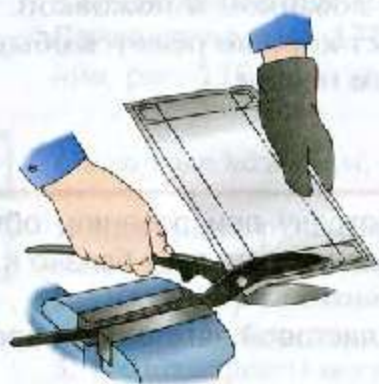
Рис. 115. Резание тонколистового металла с закреплением ножниц в тисках
