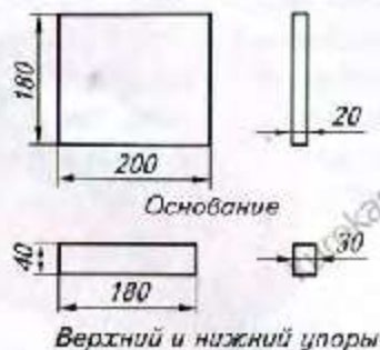
Рис. 28. Пиление с помощью приспособления (а): 1 – верхний упор; 2 – основание; 3 – заготовка; 4 – нижний упор; 5 – ножовка; 6 – верстак; эскизы деталей приспособления (б)
