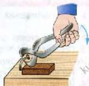
Рис. 51. Приёмы вытаскивания гвоздей: а – молотком; б – клещами
