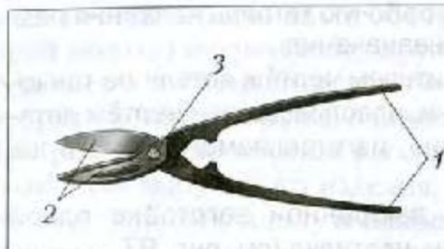
Рис. 112. Слесарные ножницы: 1 — ручки; 2 — лезвия; 3 — винт
