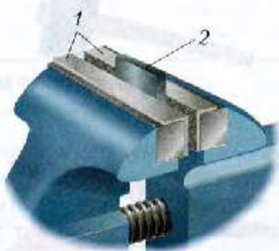
Рис. 95. Крепление заготовки из мягкого металла в тисках: 1 – нагубники; 2 – заготовка
