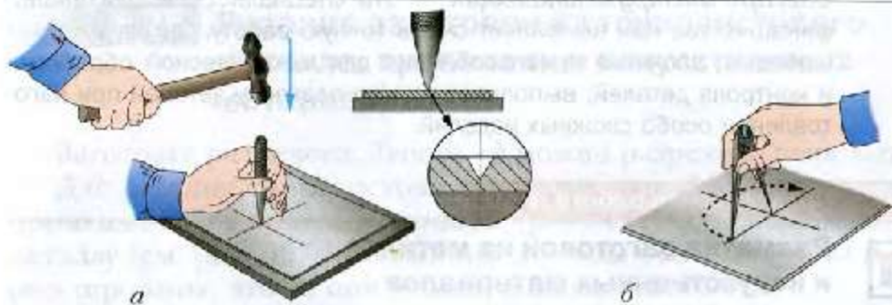
Рис. 111. Разметка окружности: а — пакеривание центра окружности; б — проведение дуги
