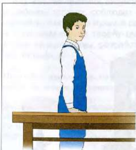
Рис. 16. Соответствие верстака росту работающего
