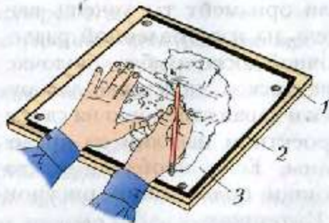
Рис. 75. Копирование рисунка на лист фанеры: 1 — фанера; 2 — копировальная бумага; 3 — рисунок
