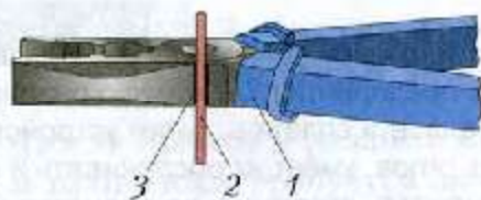
Рис. 117. Резание проволоки с помощью бокового паза плоскогубцев: 1 – плоскогубцы; 2 – проволока; 3 – боковые пазы
