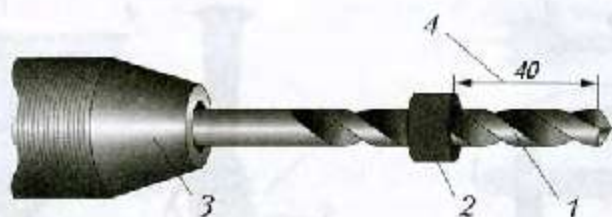
Рис. 42. Подготовка сверла для сверления глухих отверстий: 1 – сверло; 2 – ограничитель (резиновая втулка); 3 – патрон; 4 – глубина сверления)
