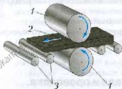
Рис. 88. Схема прокатки листового металла: 1 – валки; 2 – металлический лист; 3 – ролики
