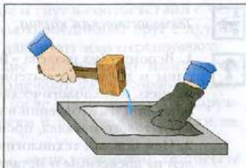
Рис. 105. Правка тонколистовой заготовки киянкой
